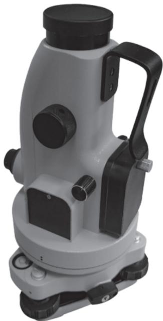
C. 旋转调焦手轮 7 至能清晰看见激光靶，平移仪器，使激光靶分别与分划板的十字丝中心重合，此时仪器电子水泡应居中，激光靶中心与分划板的十字丝中心重合；
