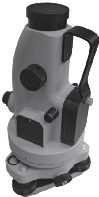
利用激光方向性强，能量集中的特点，ML403 型激光垂准仪在光学垂准系列的基础上添加二套半导体激光器。一只激光器通过上垂准望远镜将激光束发射出来，仪器的结构保证激光束轴与望远镜视准轴同轴、同心、同焦，当望远镜照准目标时，在目标处就会出现一个红色小激光亮斑；另一只激光器通过下对点系统将激光束发射出来，利用激光束对准基准点，快速直观。
