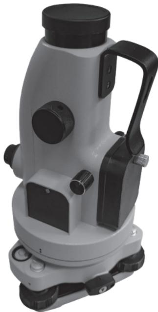
手轮 7，使激光靶清晰地成像在分划板的十字丝上，此时通过望远镜读取并记下激光靶的读数；
