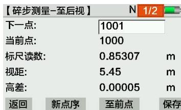
输入：下一点：输入下次要测量的点号。点号是连续的，而且随测量递增。
