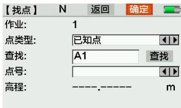
点类型：已知点、测量点，人工输入点或标准值（0.000）
