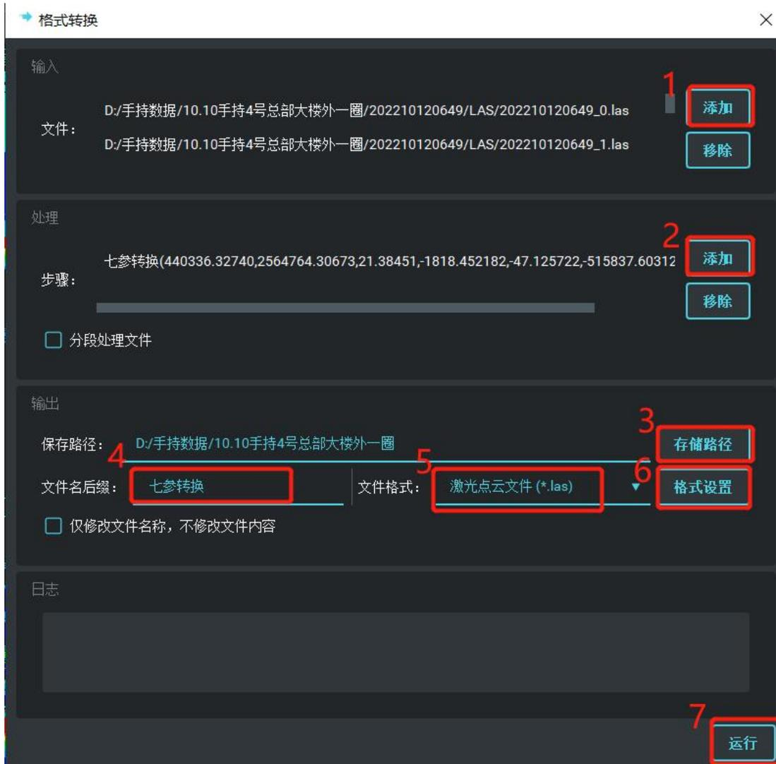
图 5-6 参数转换步骤
