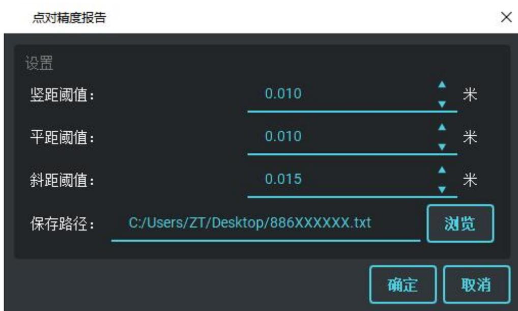
5. 按保存的路径找到生成的点对精度报告 (.txt)，打开可查看统计出的竖直方向的误差和水平方向的误差等相关参数。
