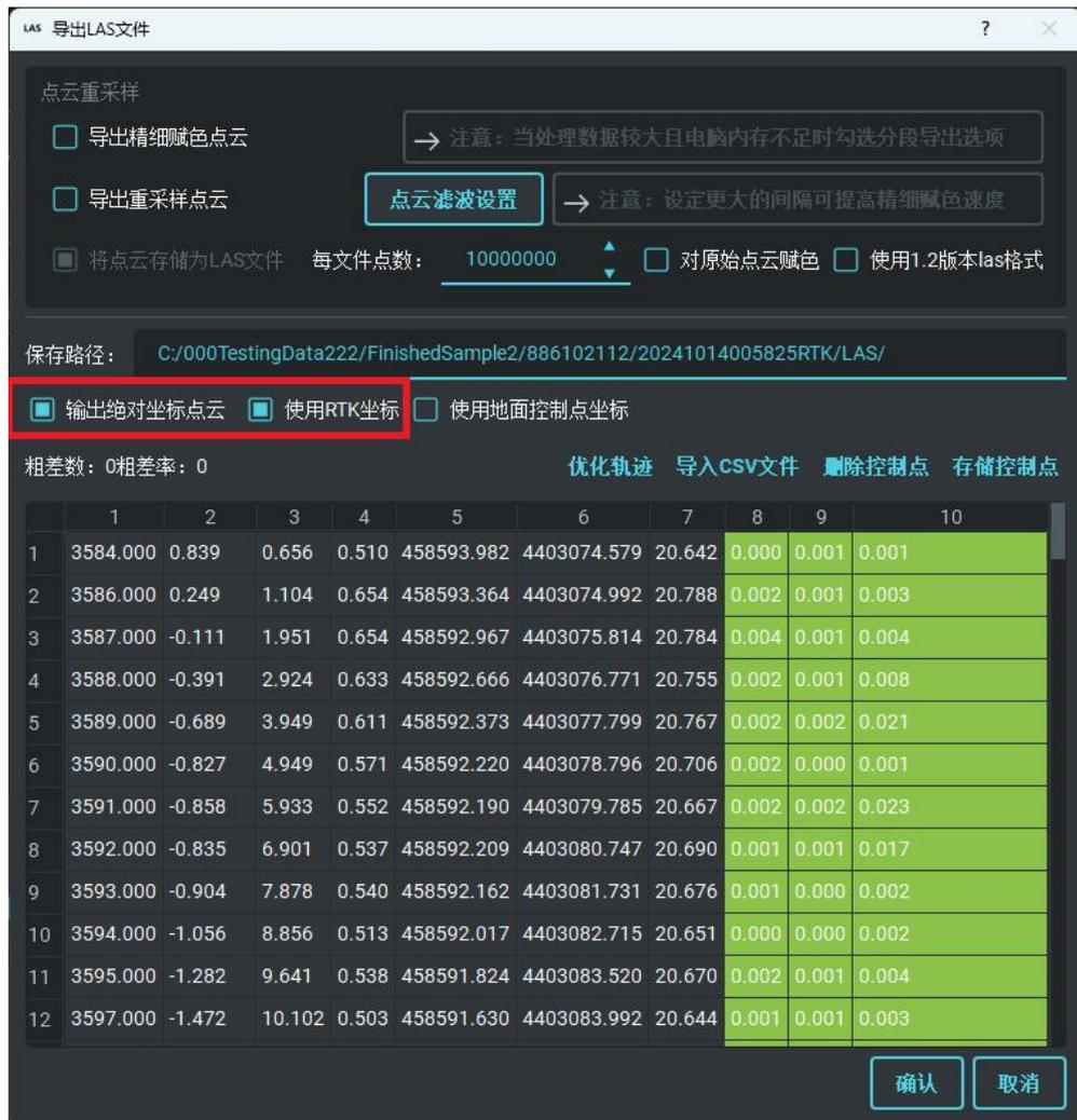
图 4-18 输出绝对坐标点云
