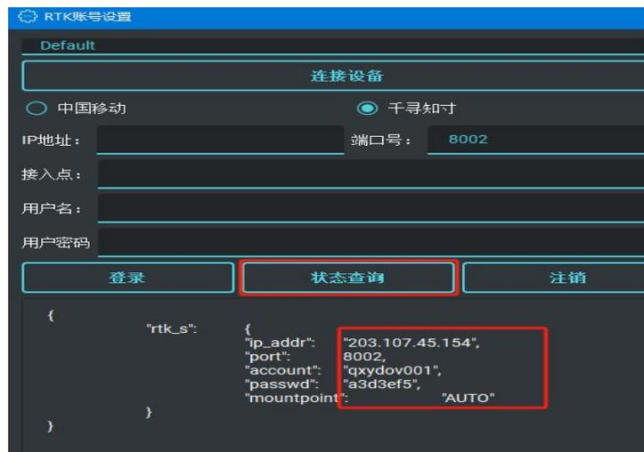
图 3-9 RTK 设置情况查询
