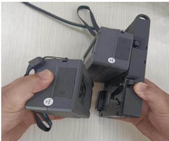
图 1-6 电池安装示意图
