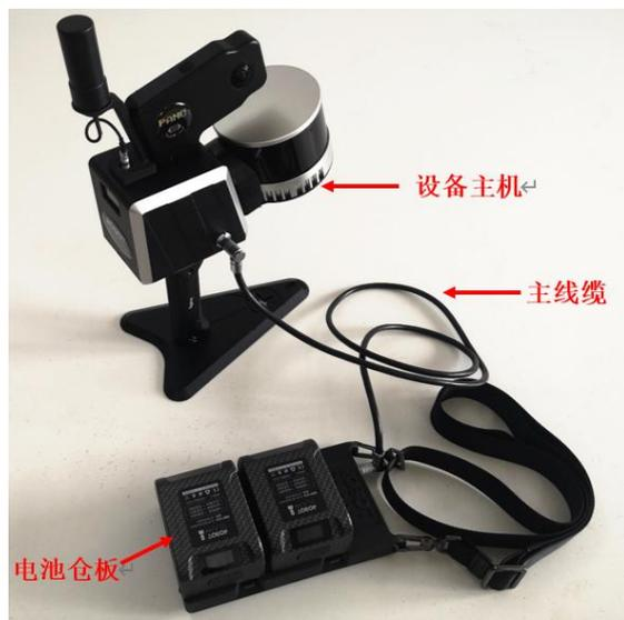
图 1-5 设备整体安装示意图
