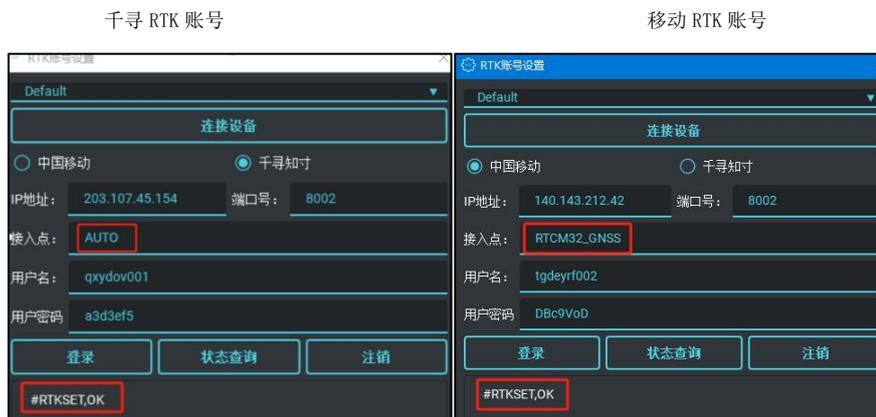
图 3-8 RTK 设置情况查询
