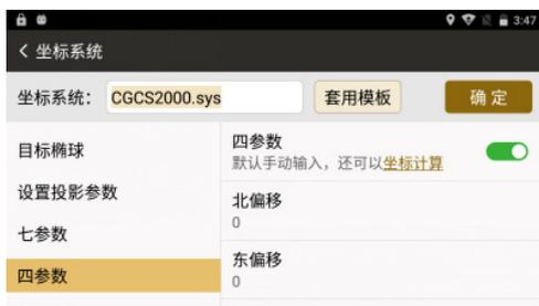
●校正参数：手动输入校正相关参数或者通过校正向导获取校正参数
