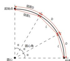
●参考弧适用于轴线为弧的测量放样,弧的定义是通过圆心加半径,或圆心加上圆上的一点,或者弧所在圆上的三点这几种方式。参考弧的方向为顺时针方向即P1到P2为顺时针。参考弧的偏移是按照弧距、弦距、径距等确定放样点在弧上投影的位置和放样点位于弧内、弧上或弧外。
