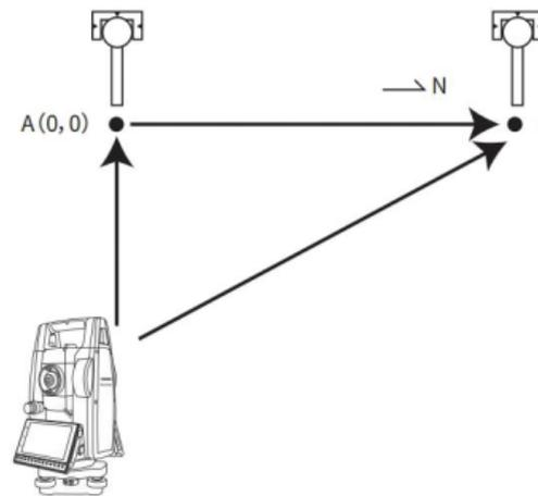
点到直线建站是通过测量空间中的一条直线，定义该直线的起点为坐标原点，起点到终点的方向为坐标北方向，建立一个独立坐标系，在通过建站点的几何关系完成建站。适用于在施工过程中借助直线桥或直线隧道的几何特点建立一个小小坐标系，方便施工放样。
