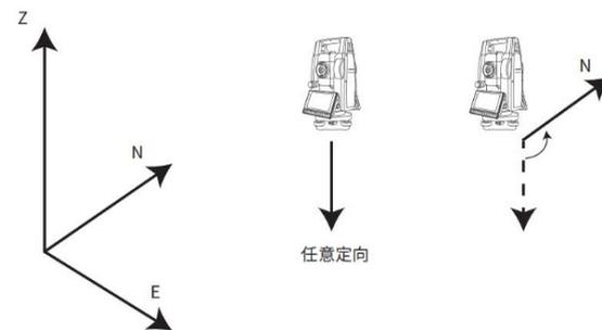
任意建站采用的是先建站后定向的作业方式，通过已知的建站点坐标建立一个坐标北方向待定的独立坐标系，在完成采集作业后，补采后视点坐标完成定向。步骤为利用一个未知坐标点进行定向（设置），建站完成后在此测站采集的点数据需进行归算，进行归算需要获取后视点的坐标。
