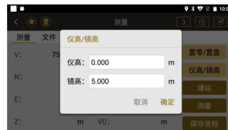
●仪高 / 镜高：输入量取的仪器高度和棱镜高度
