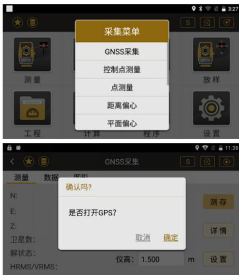
点击“GNSS 采集”，弹出提示“是否打开 GPS？”，点击确定，打开“GNSS 定位信息”，进入 GNSS 采集界面，完成数据链接后等待超站仪搜星，进行定位。
