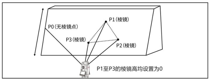
● 上面图中的三个棱镜点确定一个平面，而无棱镜点为待测点
