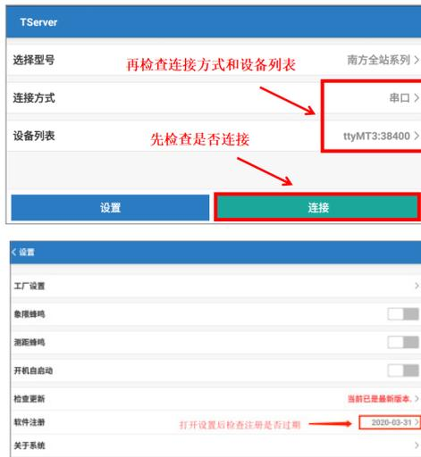
1、如果仪器在使用的过程中出现死机的情况，有可能是设备连接方式错误，请按图中所示进行连接。
