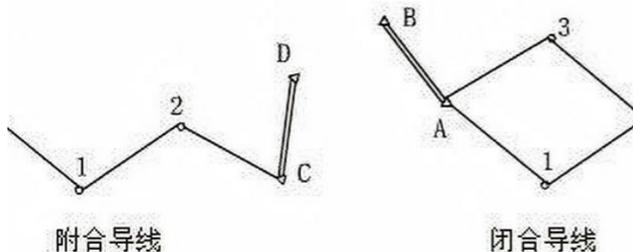
导线测量是指将一系列测点依相邻次序连成折线形式，并测定各折线边的边长和转折角，再根据起始数据推算各测点平面坐标。导线测量分为外业和内业两部分。
