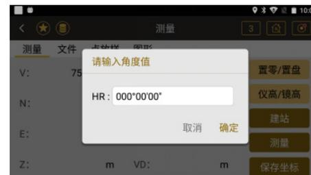
●置零 / 置盘界面，HR：输入水平角度值
