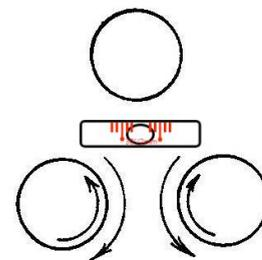
②将仪器旋转 90°，使其垂直于角螺旋 A、B 的连线。旋转角螺旋 C，使管水准气泡居中。
