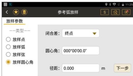
◆**径距**：在圆弧上一点到圆心的方向上，基于该点向圆外偏移径距为正，向圆内偏移径距为负。
