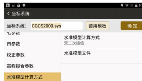
●[水准模型文件]：导入水准模型文件，提供 \*.SGF、\*.GGF 两种格式文件导入
