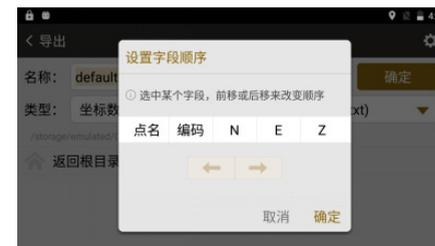
◆设置字段顺序：调整导出数据中点名、编码、N、E、Z 的顺序
