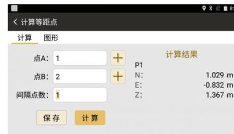
● 通过两个已知点形成一条直线，根据两点间间隔点数，计算中间各点的坐标值
