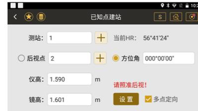
多点定向是利用三个或三个以上已知点定向同时也能利用这些点的高程来确定测站高程 (定向及传递高程)，在需要进行较高精度的测量 / 放样时，为了提高建站精度使用的建站方法，操作流程与后方交会类似，都是后视多个已知点，差别在于建站点的坐标一个是已知的，一个是未知的。
