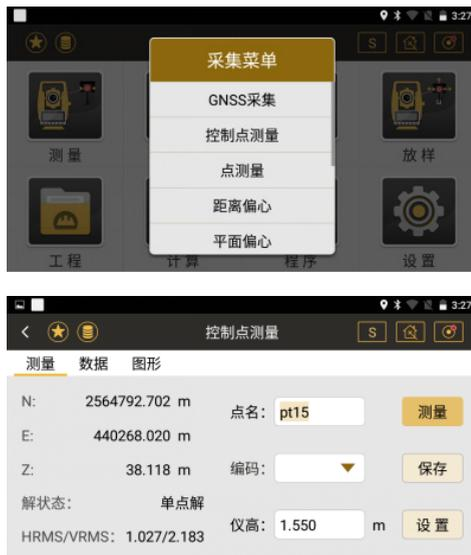
点击“控制点测量”，弹出提示“是否打开 GPS？”，点击确定，打开“GNSS 定位信息”，进入 GNSS 采集界面，完成数据链接后等待超站仪搜星，进行测量。
